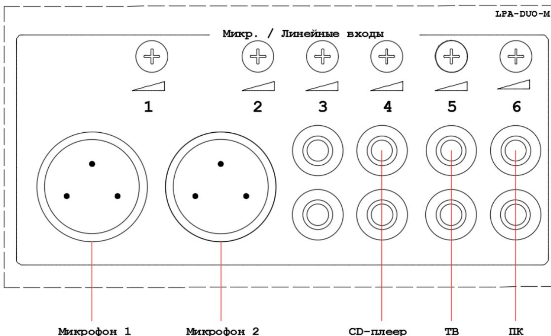
Рис. 3.10. Схема подключения внешних источников трансляции к LPA-DUO
