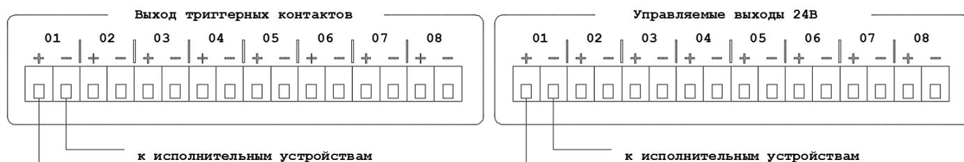
Рис. 2.3. Схема подключения внешних исполнительных устройств к LPA-DUO
