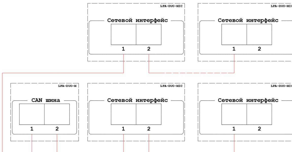
Рис. 2.3. Схема подключения удаленных микрофонных консолей к LPA-DUO
