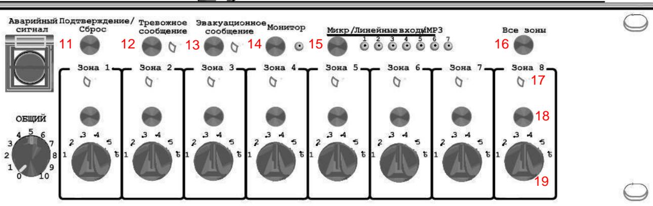
Рис. 1.1. Контроллер системы LPA-DUO-M (передняя панель)
