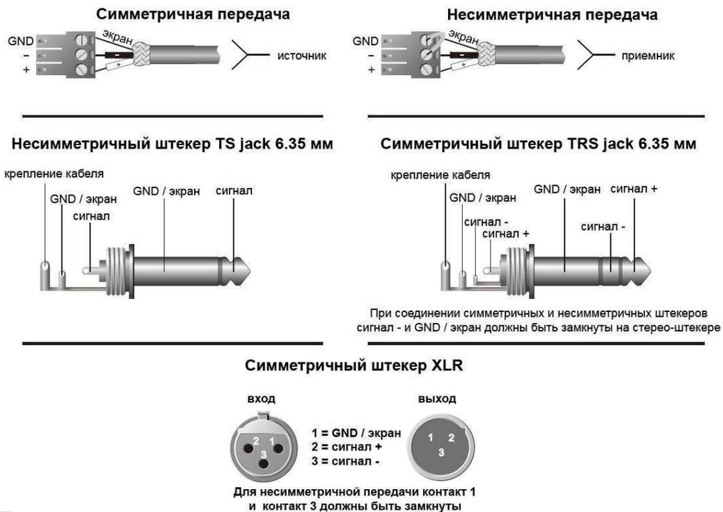
Рис. 1.1. Назначение контактов разъемов
