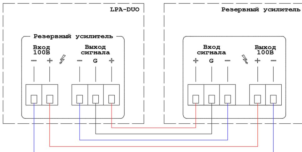
Рис. 2.3. Схема подключения резервного усилителя к LPA-DUO
