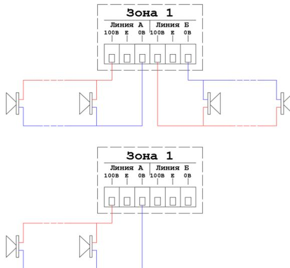
Рис. 2.3. Схема подключения трансляционных линий к LPA-DUO
